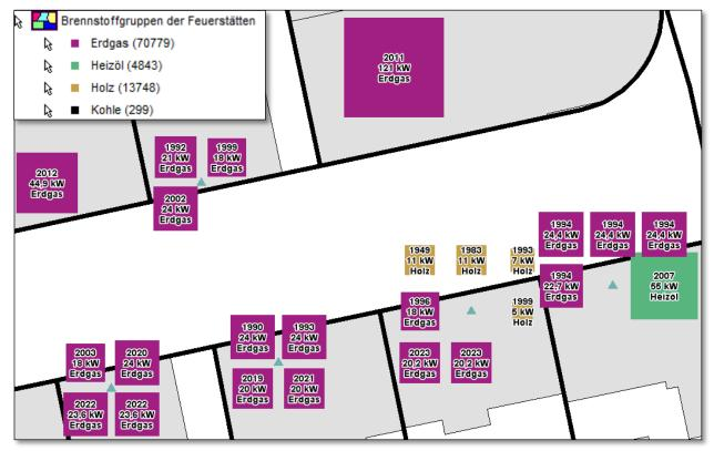
Hinweis: Die einzelnen Feuerstätten werden sortiert nach dem Baujahr der Feuerstätte und der Nennwärmeleistung von oben links nach unten rechts dargestellt. Die Flächengröße des Quadrates ist proportional zur Nennwärmeleistung der Feuerstätte.
